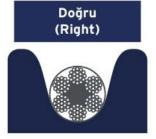
Yiv Halatın Çevresinin %33'ünü Sarmalı Sheave Groove Correctly Supporting The Rope For 33% Of It's Circumference
